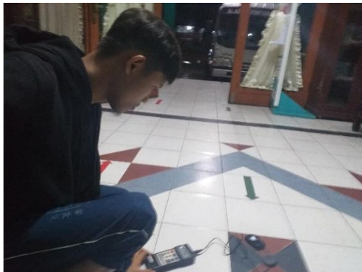
Gambar diatas adalah pengukuran kuat pencahayaan lampu pada pukul 20.00 WIB di teras penerimaan tamu, gedung SMP Islam Al-Azhar 17 Pontianak.
