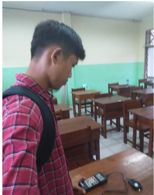
Gambar diatas adalah pengukuran kuat pencahayaan lampu pada pukul 08.10 WIB dengan menggunakan luxmeter Lutron LX-105 di ruang kelas IX-A.
