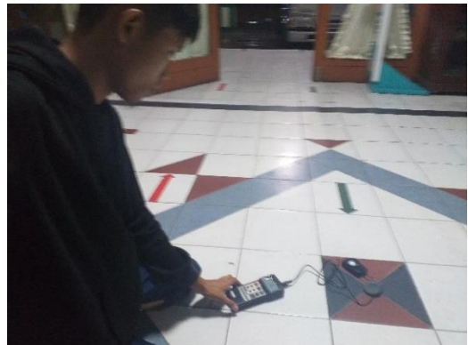
Gambar diatas adalah pengukuran kuat pencahayaan lampu pada pukul 20.00 WIB di teras penerimaan tamu, gedung SMP Islam Al-Azhar 17 Pontianak.
