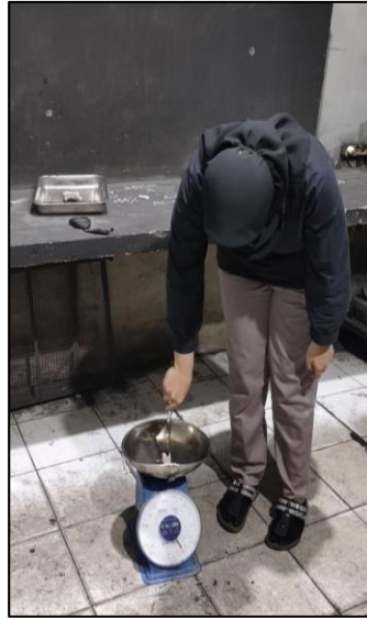
Gambar 1.1 Pengujian Density Arang Briket
