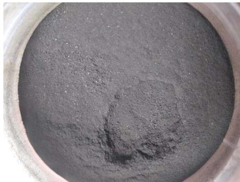
Gambar 2.1 *biochar* dari *sludge oil* kelapa sawit
