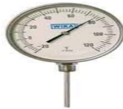
Gambar 2. 6 Termometer bimetal (Kanginan, 2002)
