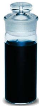
Gambar 2. 5 Pengujian Berat Jenis Aspal
