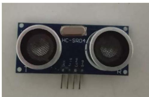
**Gambar 2.7** Sensor Ultrasonik
