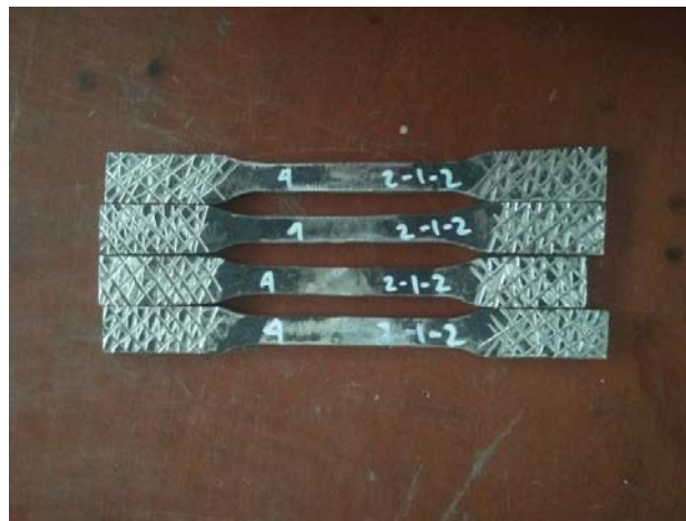
Spesimen uji tarik ASTM A36
