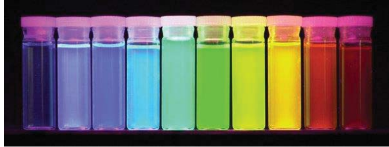
Gambar 2.1 Emisi cahaya Cadmium Selenide (CdSe) SQD dengan penurunan ukuran partikel. Warna merah menunjukkan ukuran partikel lebih besar dari 4 nm dan warna biru menunjukkan ukuran partikel kurang dari 2 nm. ( http://www.uco.es/hbarra/index.php/blog/130-puntos-cuanticos )
