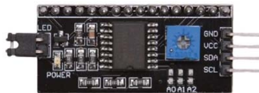
Gambar 2.7 Tampilan fisik modul I2C (Sumber: www.topwaydisplay.com )
