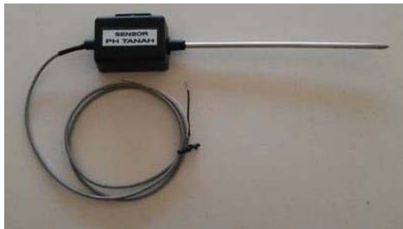
Gambar 2.3 Tampilan fisik sensor pH tanah
