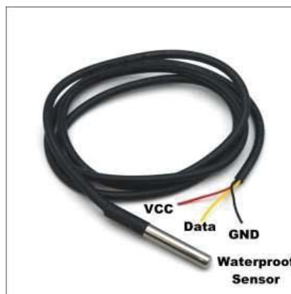
Gambar 2.4 Tampilan fisik sensor suhu DS18B20
