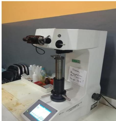
**Gambar 2.6** Alat Uji Kekerasan (*vickers*)
