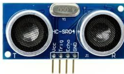
Gambar 2. 7 Konfigurasi Pin dan Tampilan Sensor HC-SR04
