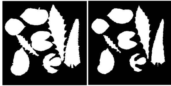
Gambar II.6 Daun-daun yang bersinggungan dapat dipisahkan melalui morfologi, yang memperkecil ukurannya (Kadir dan Susanto 2013)
