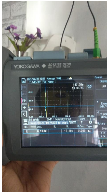
Gambar C.1 Deteksi Kabel Putus Di Samarinda
