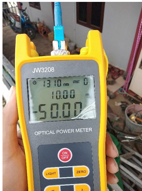
Gambar B.6 Deteksi Redaman fiber cut Pada Sambungan Pertama
