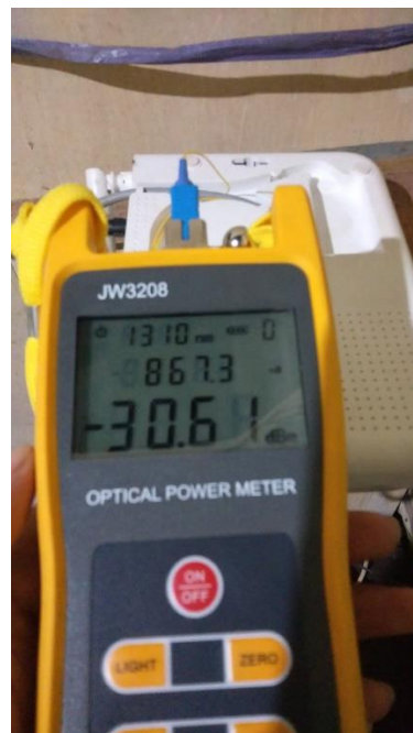
Gambar B.2 Deteksi Redaman Kabel Yang Bending di Samarinda
