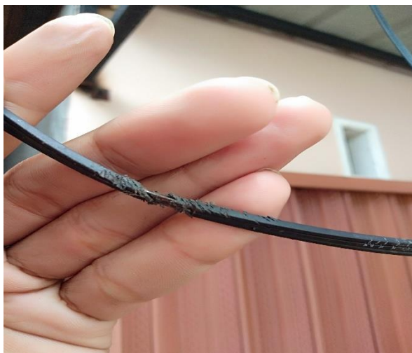
Gambar 4.16 Kabel DW Digigit Tikus
