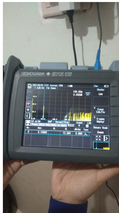
Gambar C.2 Deteksi Kabel Bending Di Samarinda
