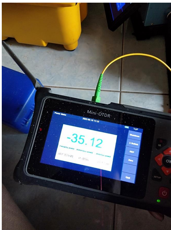
Gambar B.7 Deteksi Redaman Kabel Patchcord Yang Rusak Di Kakap
