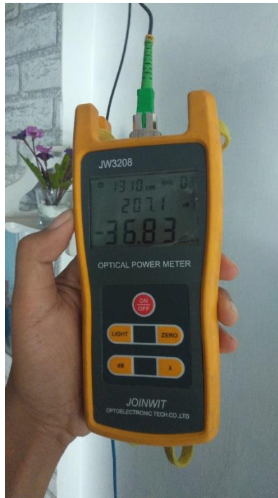
Gambar B.1 Deteksi Redaman Kabel Yang Bending di Jeruju
