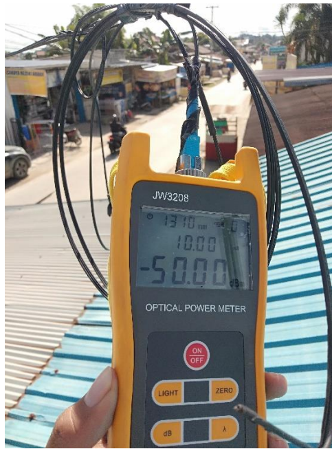
Gambar B.5 Deteksi Redaman fiber cut Pada Sambungan di Samarinda
