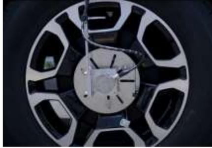
**Gambar 2.4** Rangkaian *Encoder* pada sisi ban
