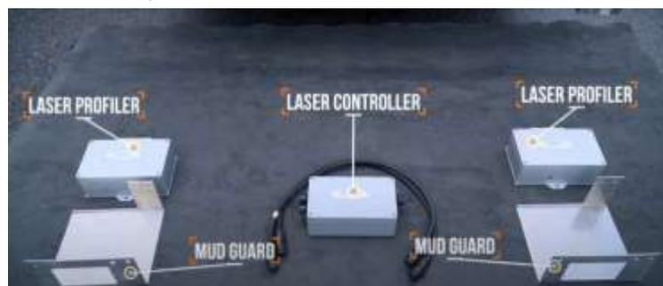
**Gambar 2.1** Komponen *Laser Profilometer*
