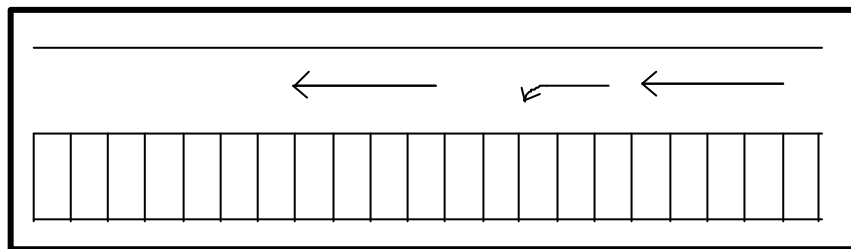
Gambar 2.2 Parkir Kendaraan Satu Sisi dengan Pola Parkir Sudut 90^\circ
