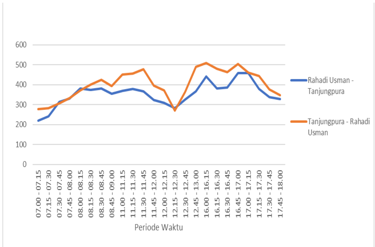
Gambar 4.4. Grafik Arus Total Kendaraan (SMP/Jam) Dari Jalan Rahadi Usman Ke Jalan Tanjungpura – Jalan Tanjungpura Ke Jalan Rahadi Usman Pada Hari Jumat Sumber : Hasil Perhitungan Volume Lalu Lintas Jalan Tanjungpura, 2022
