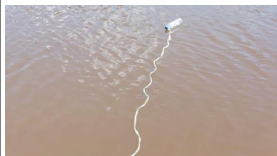
Pengukuran kecepatan arus
