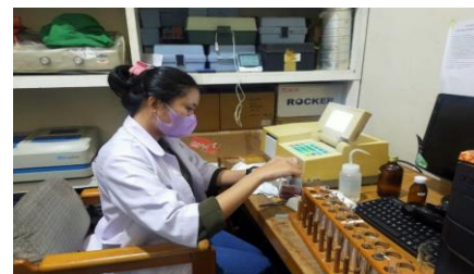
Gambar 10. Penerimaan absorbansi sampel menggunakan Spektrofotometer UV-Vis
